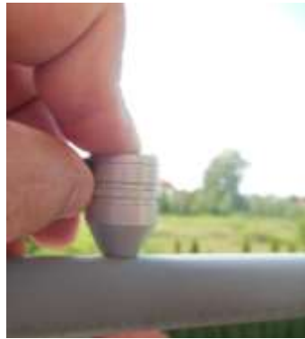
Fot. 1 Zdjęcie pokazujące niepoprawne przyłożenie głowicy na zaokrąglonej (nierównej) powierzchni.
