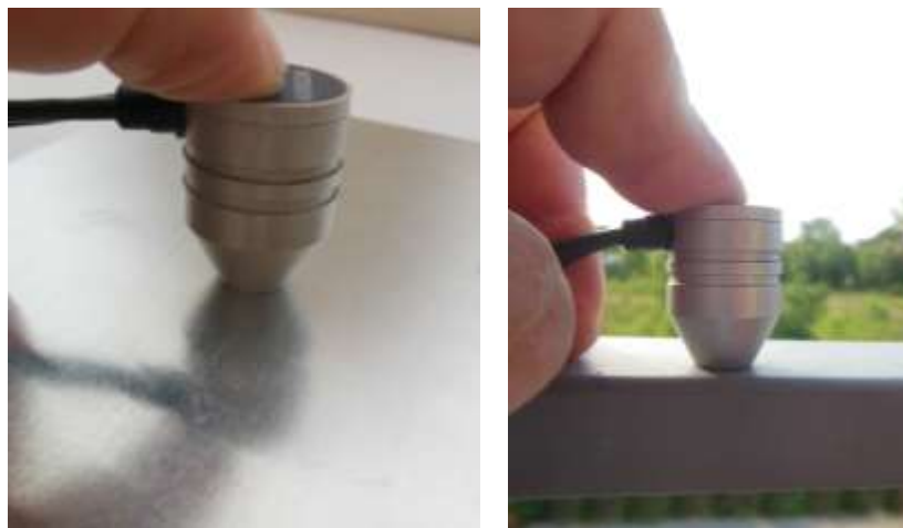
Fot. 2 Zdjęcia pokazujące poprawne przyłożenie głowicy na badanej powierzchni.
